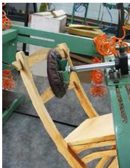
รูปที่ 12 การทดสอบความแข็งแรง ของพนักพิงโดยใช้แรงกระทำตรงกลางของพนักพิงของเก้าอี้ ด้วยน้ำหนัก 560 นิวตันโดยไม่มีน้ำหนักถ่วงสมดุลลงบนที่นั่ง จำนวน 10 ครั้ง
