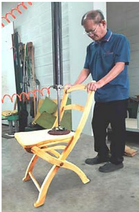
รูปที่ 9 การทดสอบความแข็งแรง โดยการใช้แรงกดจากแนวดิ่งด้วยน้ำหนัก 900 นิวตันลงบนพื้นนั่งจำนวน 10 ครั้ง
