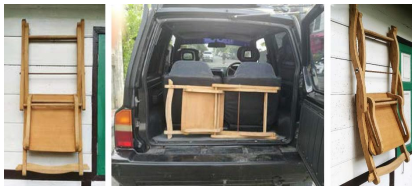
รูปที่ 14 รวมภาพการทดสอบ การพับแขวนบนผนัง การพับพกพาเก็บในรถยนต์
