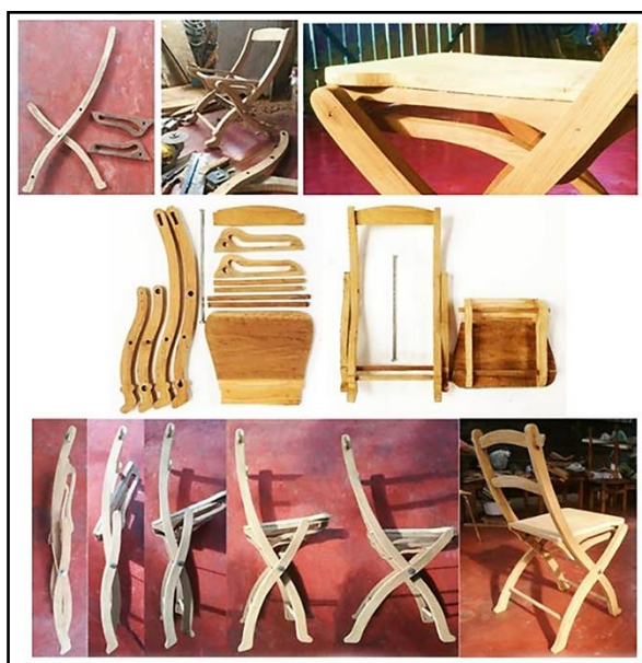
รูปที่ 8 ภาพแสดงการผลิตสร้างต้นแบบ และทุกชิ้นส่วนที่ใช้ประกอบขึ้นรูป พร้อมทำการทดสอบกลไกและวิธีการพับเก้าอี้พับรูปแบบ C
