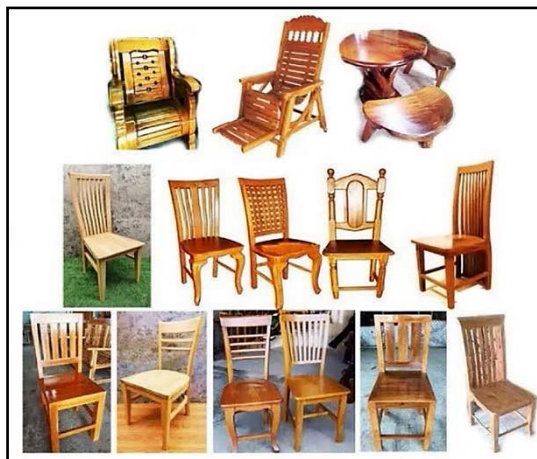
รูปที่ 1 ภาพรวมเก้าอี้หลายรูปแบบ ผลิตโดยกลุ่มวิสาหกิจชุมชนงานไม้และเฟอร์นิเจอร์บ้านดอนมูล จ.แพร่ ทำด้วยไม้จริง ขนาดใหญ่ หนา น้ำหนักมาก โครงสร้าง เทคนิคการเข้าเดือย จุดเชื่อมต่อแบบยึดตาย ไม่สามารถปรับเปลี่ยนรูปร่างลดขนาดให้เล็ก และลดน้ำหนักให้เบาลง ทำได้ยาก
