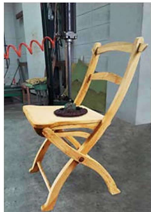
รูปที่ 10 ทดสอบด้วยการใช้แรงกระทำจากแนวดิ่งโดยใช้ตุ้มน้ำหนัก 250 นิวตัน (25 กก.) สูงจากพื้นนั่ง 30 ซม. ปลดปล่อยกระแทกอิสระลงบนพื้นนั่ง จำนวน 10 ครั้ง
