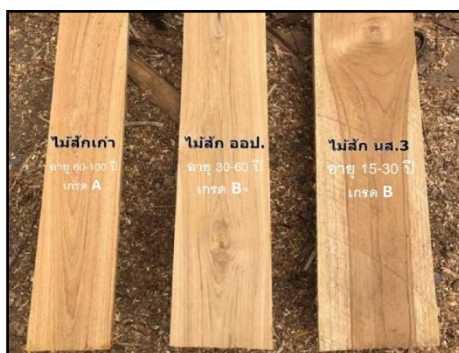
รูปที่ 3 ภาพไม้สัก เรียงลำดับตามอายุไม้สัก เกรด A, B+ และ B ที่จำหน่ายในตลาดค้าไม้แปรรูปที่ อ.สูงเม่น จ.แพร่
