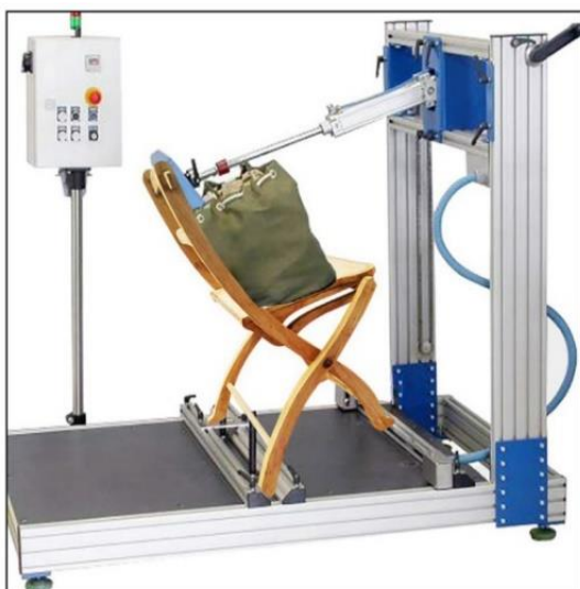
รูปที่ 11 การทดสอบความแข็งแรงของพนักพิงใช้แรงกดกระทำในระดับของพนักพิง 560 นิวตัน โดยมีน้ำหนักถ่วงสมดุลบนที่นั่งโดยมีที่ยึดกันขาหน้า-ขาหลังกันเลื่อน จำนวน 10 ครั้ง
