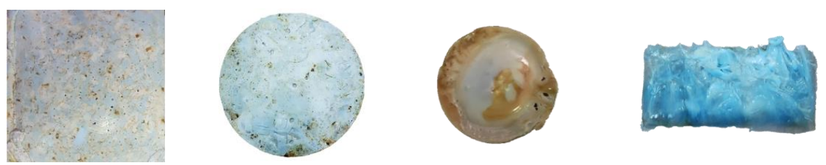
ภาพที่ 5 การหลอมขยะขวดน้ำพลาสติกในอุณหภูมิที่ 230 องศาเซลเซียส
