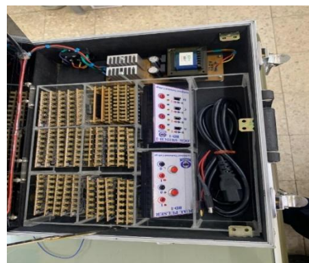
(ข) แผ่นวงจรพิมพ์ชุดฝึกที่บรรจุในกระเป๋ 32 แผ่น
