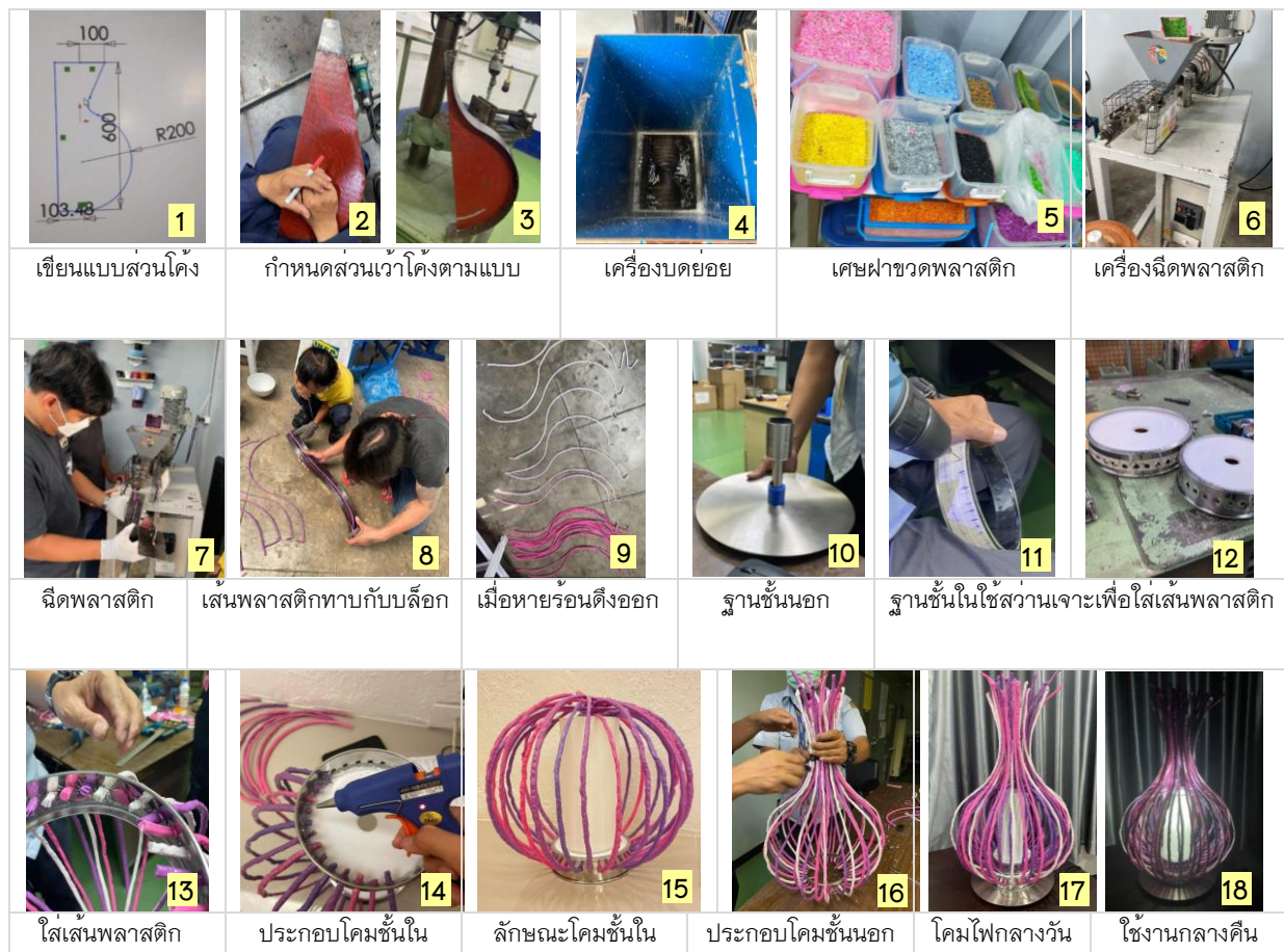
ภาพที่ 3 แสดงกระบวนการรีไซเคิลฝาขวดพลาสติกเพื่อผลิตต้นแบบผลิตภัณฑ์โคมไฟตั้งโต๊ะ
