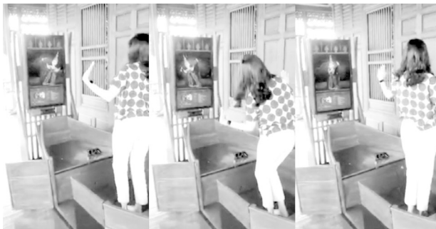
ภาพที่ 14 ภาพเล่นกับหุ่นสามมิติผ่านเซ็นเซอร์ ตัวหุ่นสามารถขยับแขน ขยับลำตัว ขยับไหล่ และขยับคอไปตามการเคลื่อนไหวของร่างกายได้
