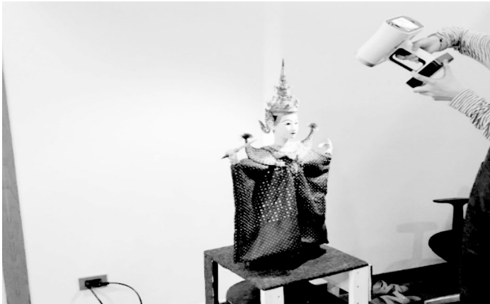
ภาพที่ 3 การสแกนสามมิติหุ่นกระบอก
