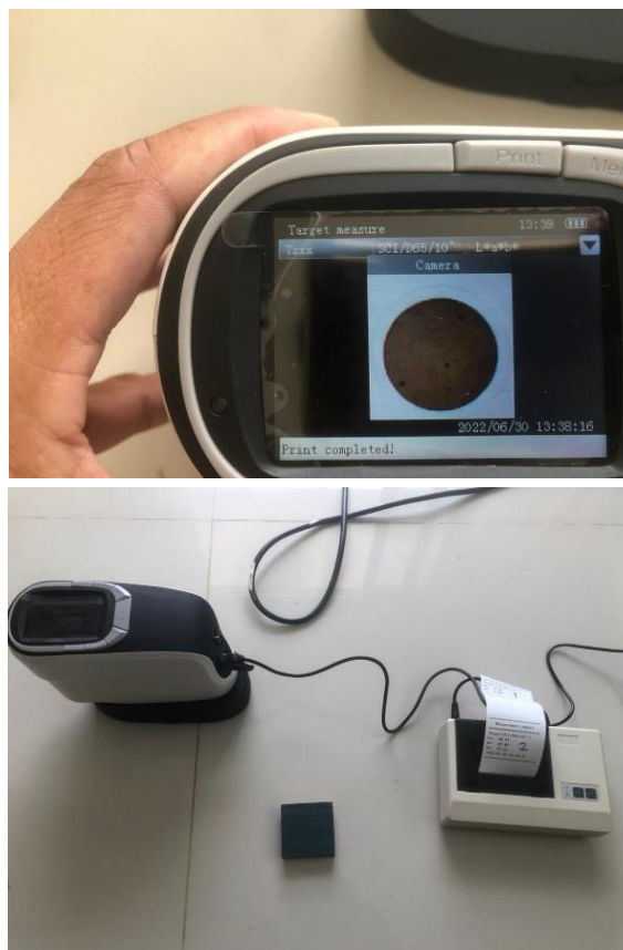
ภาพที่ 5 การวัดค่าสีบนแผ่นทดลองด้วยเครื่องสแกนวัดค่าสี
