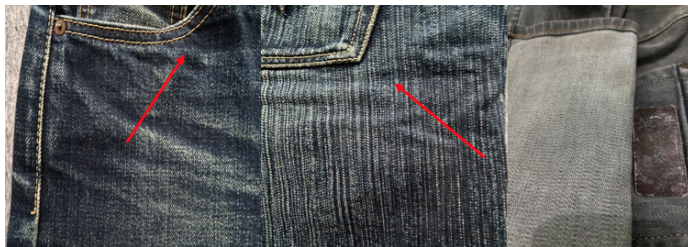
ภาพที่ 1 ตัวอย่างผ้าทอ (ซ้าย) ลายเฉียงขวา Iron Heart IH-777N (กลาง) ลายเฉียงซ้าย Flat Head x R.J.B D109FXR (ขวา) ลายผ้าซิกแซกเอกลักษณ์ของแรงเลอร์
