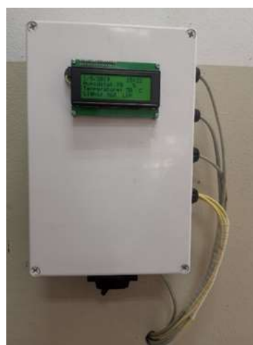
ภาพที่ 2 การติดตั้งอุปกรณ์ในกล่องควบคุมการทำงานของโรงเพาะชำอัตโนมัติ
