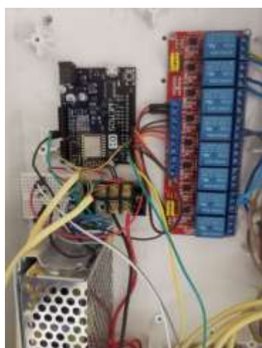
ภาพที่ 2 การติดตั้งอุปกรณ์ในกล่องควบคุมการทำงานของโรงเพาะชำอัตโนมัติ
