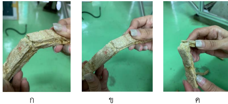
ภาพที่ 2 ลักษณะการหักของตัวอย่างชิ้นงานที่ใช้ทดสอบภาดรองไข่ชาน้อย ก ,ข และ ค คือ มุมที่ขึ้นคือ 15 องศา 30 องศาและ 45 องศา ตามลำดับ
