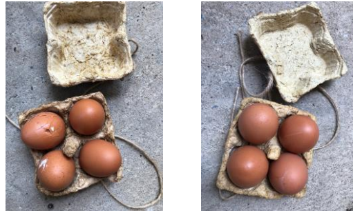
ภาพที่ 4 อัตราการแตกของไข่ไก่เมื่อปล่อยถาดรองไข่ที่ความสูง 50 เซนติเมตร
