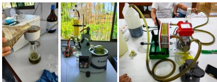
ภาพที่ 2 การสกัดน้ำมันอะโวคาโดด้วยตัวทำละลายเฮกเซน เอทานอล และการกรองน้ำมัน
