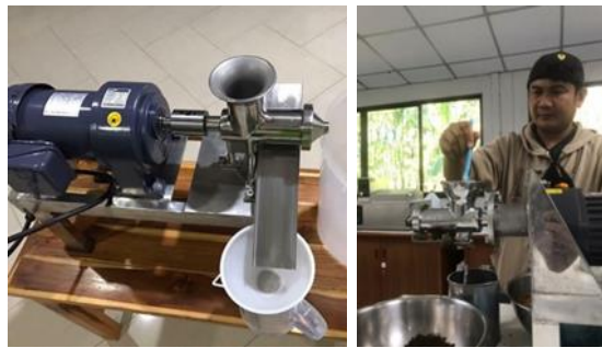
ภาพที่ 1 การสกัดน้ำมันอะโวคาโดด้วยเครื่องอัดบีบขนาดเล็ก (บริษัทเนเจอร์ เฮลท์ แอนด์ อินโนเวชั่น จำกัด, 2564)
