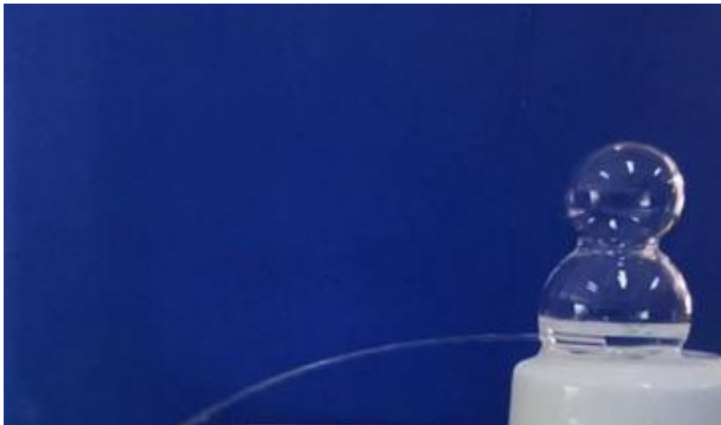
ภาพที่ 2 แสดงการพุ่งของน้ำออกมาจากรูด้านหน้าของตุ๊กตาเมื่อราดน้ำร้อนลงบนตัวตุ๊กตา
