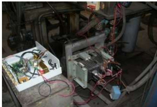
ภาพที่ 14 เครื่องเชื่อมโซ่ขณะทำงานการเชื่อมโซ่ขนาด 5 mm
