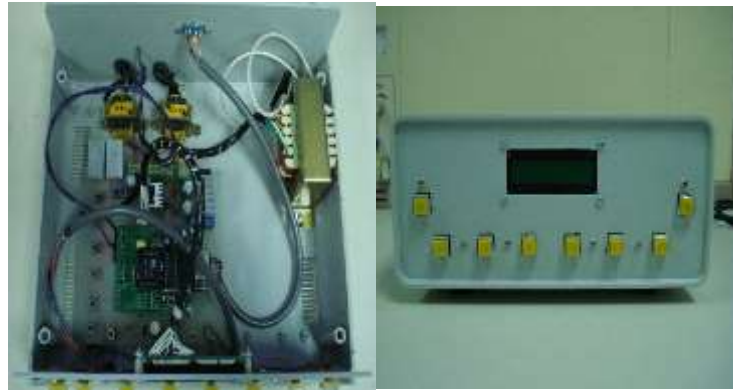
ภาพที่ 6 ชุดไมโครคอนโทรลเลอร์สำหรับสร้างสัญญาณจุดชนวนเอสซีอาร์
