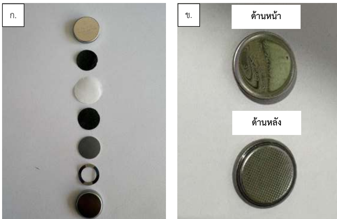
ภาพที่ 3 (ก) ส่วนประกอบของเซลล์ทรงเหรียญ และ (ข) ตัวเก็บประจุยิ่งยวดที่ประกอบเสร็จแล้วแบบเซลล์ทรงเหรียญ
