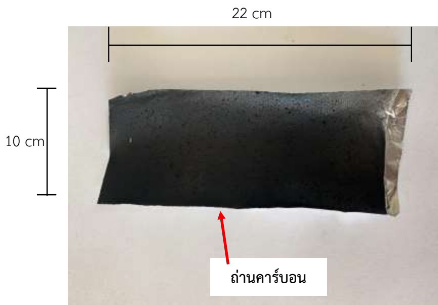
ภาพที่ 2 ฟิล์มคาร์บอนใช้เป็นขั้วไฟฟ้าของตัวเก็บประจุยิ่งยวด
