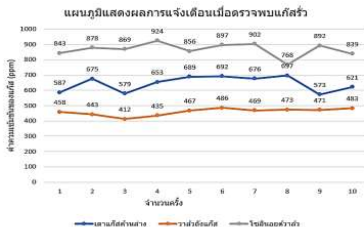
ภาพที่ 8 ประสิทธิภาพการตรวจจับค่าความเข้มข้นของแก๊สที่เกิดการรั่วของเซนเซอร์ทั้งสามตำแหน่ง
