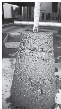
รูปที่ 7 แสดงการยุบตัวของคอนกรีตทุกๆ 15 นาที
