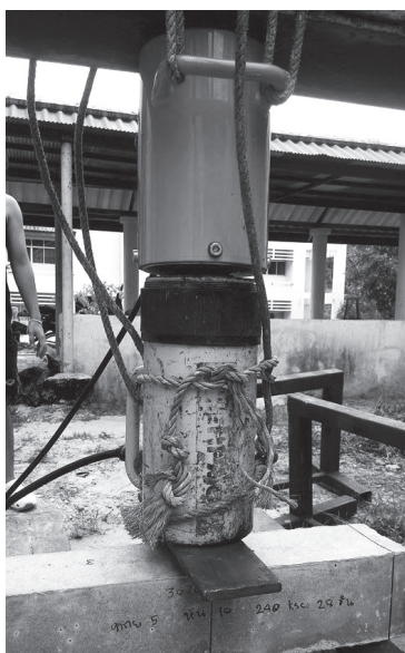
รูปที่ 9 แสดงการทดสอบแรงดัดของคอนกรีต
