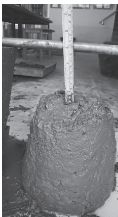
รูปที่ 7 แสดงการยุบตัวของคอนกรีตทุกๆ 15 นาที
