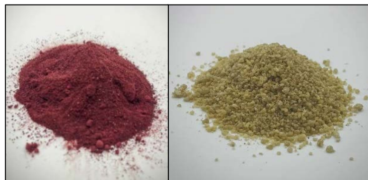
ภาพที่ 12 การแสดงลักษณะของเนื้อวัสดุไบโอเรซิน สูตรที่ 13.9 และเม็ดสีกระเจี๊ยบ
