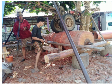
ภาพที่ 5 การกลึงกลองหลวง โดยใช้รถไถทุนแรงคน ที่มา: พระอัมรินทร์ ชยานันโท
