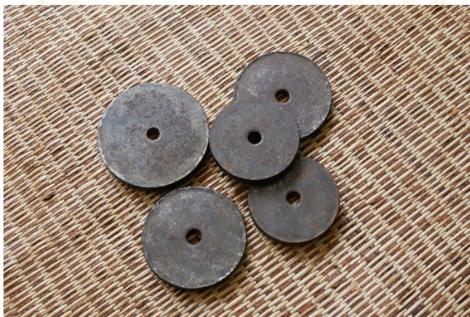
ภาพที่ 10 บล็อกแผ่นเหล็กที่ใช้อัดประกบหนังสำหรับชั้นทุบหรือนวดหนัง ที่มา : ผู้เขียน
