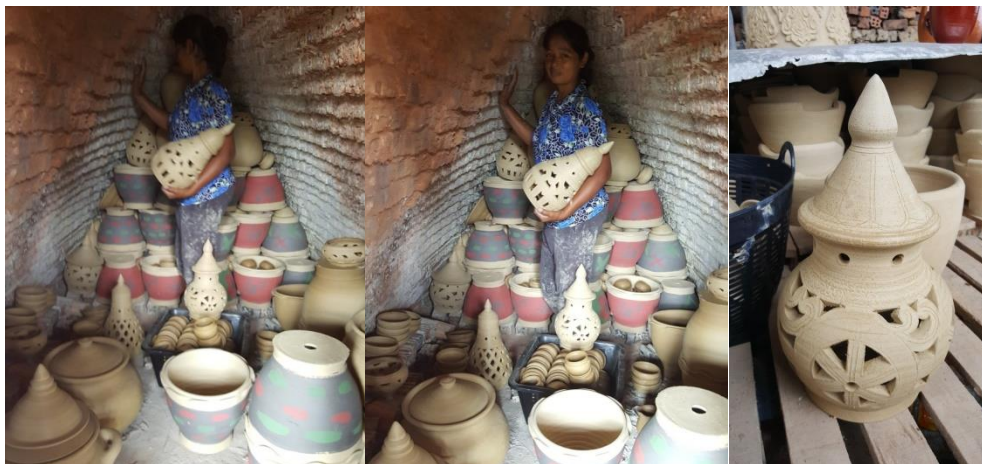
ภาพที่ 6 แสดงภาพกระบวนการนำต้นแบบผลิตภัณฑ์เครื่องปั้นดินเผาเข้าเตาเผา ที่มา : Suksikan, J. (2019)
