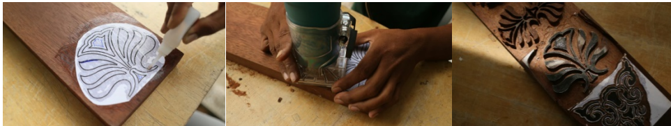
ภาพที่ 5 ขั้นตอนการกำหนดขนาดและเจียหน้าไม้ด้วยเครื่องทิมเมอร์
