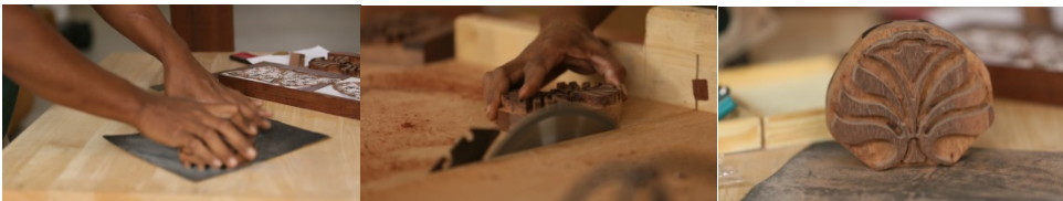
ภาพที่ 6 ขั้นตอนการตกแต่งเพื่อเก็บรายละเอียดแม่พิมพ์ไม้
