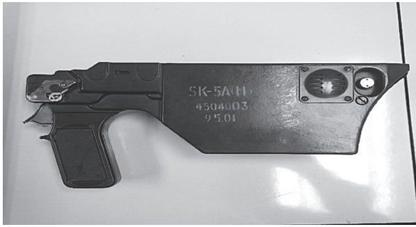
รูปที่ ๕ : ภาพถ่ายชุดสั่งยิง (Gripstock) ที่จะนำมาใช้ในการสเก็ตขึ้นรูป
