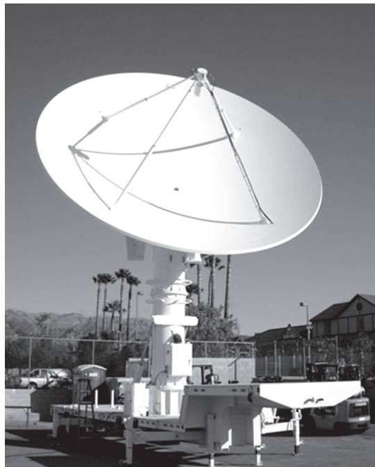
รูปที่ ๕ งานสายอากาศติดตามเป้าหมาย (Tracking Antenna) ขนาด ๒.๔ เมตร แบบติดตั้งประจำที่ และแบบติดตั้งบนรถลาก
