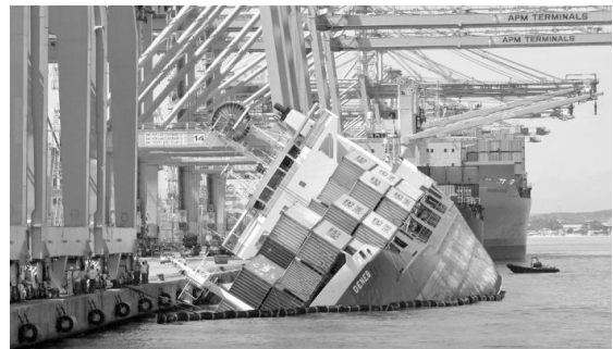
ภาพที่ ๑ การบรรทุกสินค้าลงเรือเกินน้ำหนักทำให้เรือเสียการทรงตัวในเขตพื้นที่ท่าเรือ ๖
