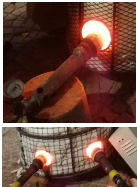
ภาพที่ ๓ หัวเบอร์เนอร์หรือหัวพ่นไฟ เป็นวัสดุอุปกรณ์ที่ใช้ในการพ่นเปลวไฟเข้าไปในเตาเผาเพื่อเผาให้เคลือบหลอมละลายที่อุณหภูมิที่ ๑,๐๕๐ องศาเซลเซียส ที่ได้จากเชื้อเพลิงแก๊ส (LPG) เป็นเชื้อเพลิงหลัก
