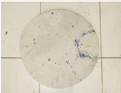
ภาพที่ ๕ แผ่นรองเตาทนความร้อน เป็นแผ่นที่รองผลงานภายในเตาเผาสามารถซ้อนกันได้หลายชั้น และขารองแผ่นรองทนความร้อน
