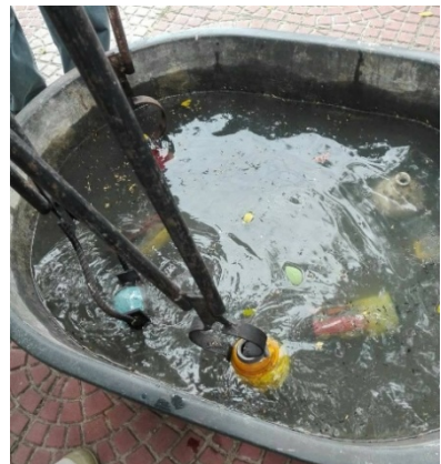
ภาพที่ ๑๒ การคีบชิ้นงานจากภาชนะที่บ่มทำหน้าที่ในการสร้างบรรยากาศไม่สมบูรณ์ นำมาแช่น้ำเพื่อให้ชิ้นงานเย็นลงอย่างฉับพลัน
