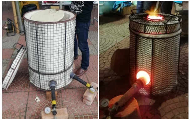
ภาพที่ ๒ เตาเผารากู ประกอบด้วย ไฟเบอร์ใยแก้วทนความร้อน ๑,๔๐๐ องศาเซลเซียส โครงสร้างเตาทำด้วยโลหะทำหน้าที่ห่อล้อมวัสดุทนความร้อนให้ได้รับทรงกลม
