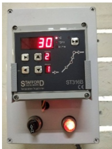
ภาพที่ ๔ ตัววัดอุณหภูมิภายในเตา (Thermocouple) มีส่วนประกอบสองส่วน คือ เทอร์โมคัปเปิ้ลและส่วนเครื่องบันทึกอุณหภูมิ
