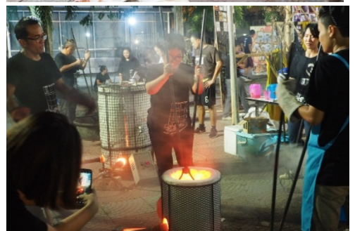
ภาพที่ ๑๐ วิทยากร และชาวจังหวัดนครศรีธรรมราช กำลังสืบชิ้นงานขึ้นจากเตาเผา ที่อุณหภูมิ ๑,๐๕๐ องศา เซลเซียส ซึ่งขั้นตอนนี้ต้องระมัดระวังเรื่องความปลอดภัย ต่อร่างกายและต้องใส่ถุงมือทุกครั้ง
