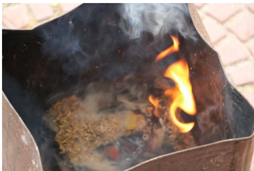
ภาพที่ ๑๑ การนำชิ้นงานจากเตาเผาอื่นๆ มาใส่ภาชนะที่มีซี่เหล็ย แกลบ ใบไม้ เพื่อบ่มทำหน้าที่ในการสร้างบรรยากาศไม่สมบูรณ์ ทำให้เกิดการเปลี่ยนแปลงของสีเคลือบและเนื้อดิน
