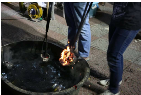
ภาพที่ ๑๑ การนำชิ้นงานจากเตาเผาอื่นๆ มาใส่ภาชนะที่มีซี่เหล็ย แกลบ ใบไม้ เพื่อบ่มทำหน้าที่ในการสร้างบรรยากาศไม่สมบูรณ์ ทำให้เกิดการเปลี่ยนแปลงของสีเคลือบและเนื้อดิน
