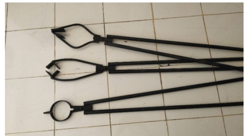
ภาพที่ ๖ ถุงมือกันความร้อน จำเป็นต้องใช้ถุงมือทุกครั้งเมื่อปฏิบัติงาน เพื่อป้องกันความร้อนสัมผัสมือเราโดยตรง และคีมคีบชิ้นงาน เป็นคีมคีบที่ทำมาจากโลหะ ไว้สำหรับคีบชิ้นงานภายในเตาเผา ในขณะที่อุณหภูมิ ๑,๐๕๐ องศาเซลเซียส
