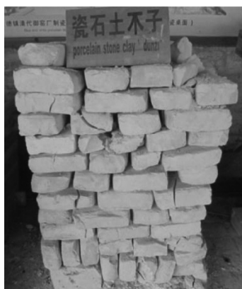
ภาพที่ 3 หลังจากบดและล้างหินพอร์ซเลนแล้วจะนำมาทำเป็นก้อนคล้ายอิฐไว้ เรียกว่า dunzi (หรือ petuntse) ส่วนหนึ่งก็นำไปเป็นส่วนผสมของเคลือบ (glaze) ด้วย
