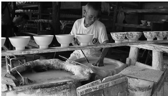
ภาพที่ 4 ภาชนะที่แห้งดีและแต่งเรียบร้อยแล้ว จะนำไปส่วนเคลือบ โดยไม่มีการเผาดิบ (bisque firing) ก่อน จะมีภาชนะอยู่สองกลุ่มในการเคลือบ คือ กลุ่มที่สามารถเคลือบได้เลย เพื่อจะได้นำไปตกแต่งเขียนสีบนเคลือบต่อไป กับอีกกลุ่ม คือ ภาชนะที่ได้ตกแต่งเขียนสีใต้เคลือบมาแล้วจึงนำมาเคลือบ
