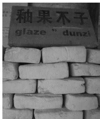
ภาพที่ 3 หลังจากบดและล้างหินพอร์ซเลนแล้วจะนำมาทำเป็นก้อนคล้ายอิฐไว้ เรียกว่า dunzi (หรือ petuntse) ส่วนหนึ่งก็นำไปเป็นส่วนผสมของเคลือบ (glaze) ด้วย
