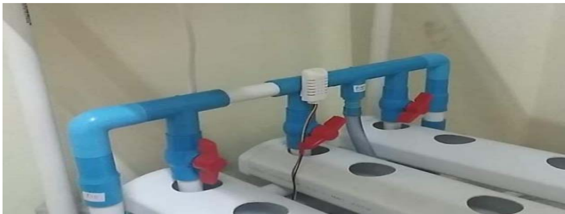
ภาพที่ 9 อุปกรณ์เซ็นเซอร์ตรวจวัดค่าอุณหภูมิและความชื้นภายในโรงเรือน
