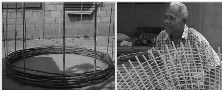
ภาพประกอบที่ 5 การขึ้นโครงสร้างเสวียนด้วยไม้ไผ่สาน
